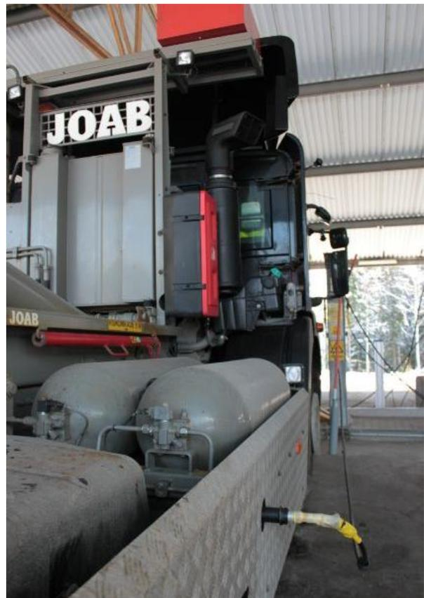
Biocarburants – Camion fonctionnant au biogaz en ravitaillement – Source : Dominic Lapointe
