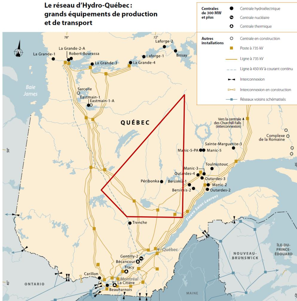
La répartition de l'énergie au niveau régional se fait par l'intermédiaire d'un certain nombre de sous-réseaux alimentés par le réseau à 735 kV ou par des centrales régionales. Les sous-réseaux sont aussi conçus et exploités pour intégrer simultanément la production maximale des centrales qui y sont raccordées et alimentées.
